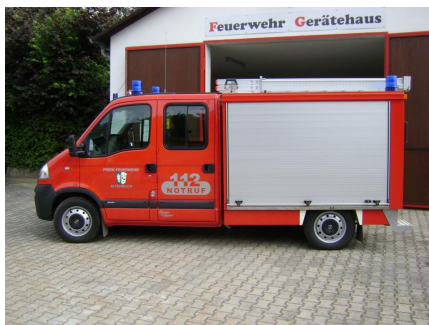
Bildunterschrift: Neue Generation eines Tragkraftspritzenfahrzeugs TSF mit 4,2 to
