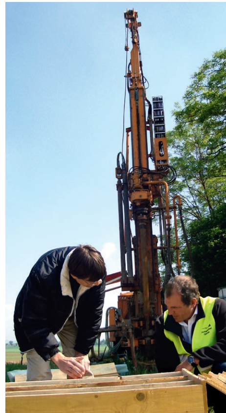
Aufnahme von Bohrdaten einer LfU-Forschungsbohrung
